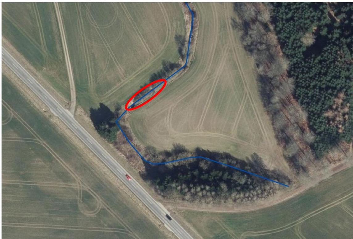
Strækningen af Dyndkær Bæk, hvor der fjernes en rørbro og etableres sandfang, er markeret med en rød ring
